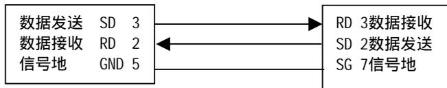
RS232接口, 只能单台点对点的通讯, 不能进行总线的并联。
